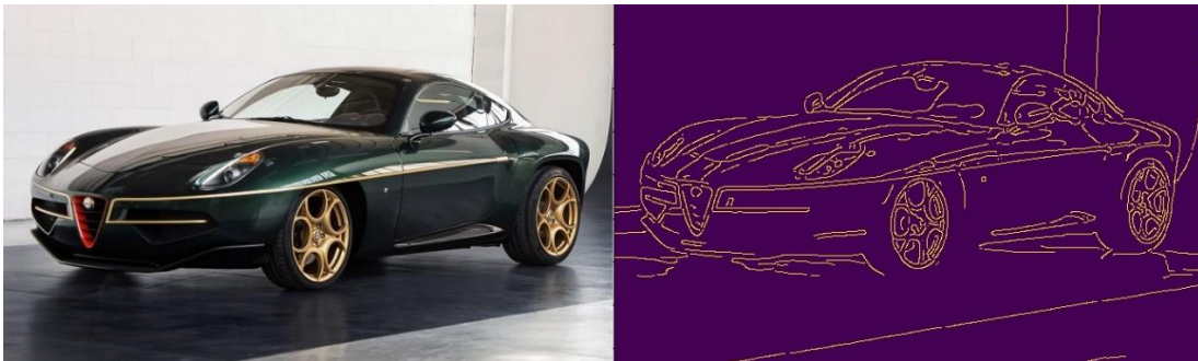
Figura 11.4 Immagine di una Alfa Romeo Disco Volante (a sinistra), i contorni rilevati (a destra) dopo l'applicazione del Canny Edge Detector.
