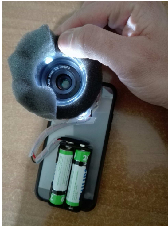
Figura 6: Dispositivo hardware per l'acquisizione delle foto con LEDs accesi
